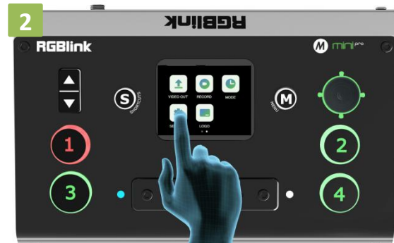
2. Press the 【M】 button to enter 【Settings】 -- 【IP Setting】 menu.
